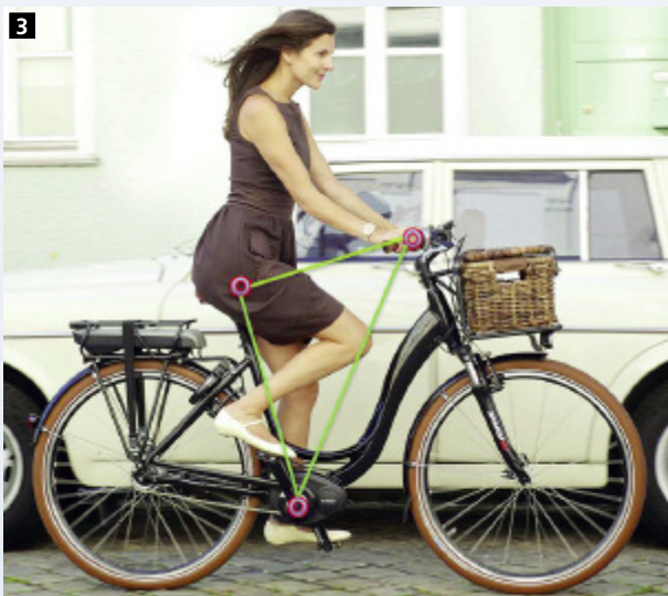
Die wichtigsten Einflussgrößen auf die Fahrradergonomie sind die Schnittstellen zwischen Mensch und Fahrrad: Sattel, Lenker und Pedalen beziehungsweise Tretlager.
