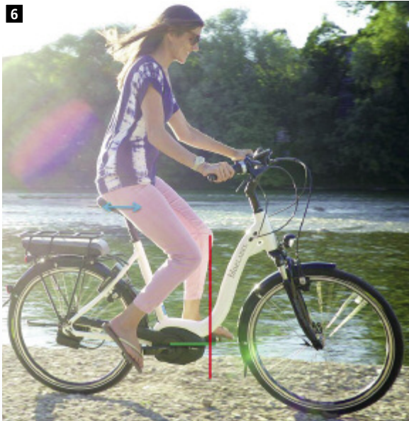
Der Zweiradmechanikermeister Peter Horsch ermittelt die Sitzlänge so: „Bei waagrecht stehender Kurbel (grüne Linie) lässt sich ein Lot (rote Linie) von der Vorderseite des Knies durch die Pedalachse fallen. [...] Der Sattel kann stufenlos nach vorn oder hinten geschoben werden (blaue Linie), um die ideale Position zu erreichen.“ 4
